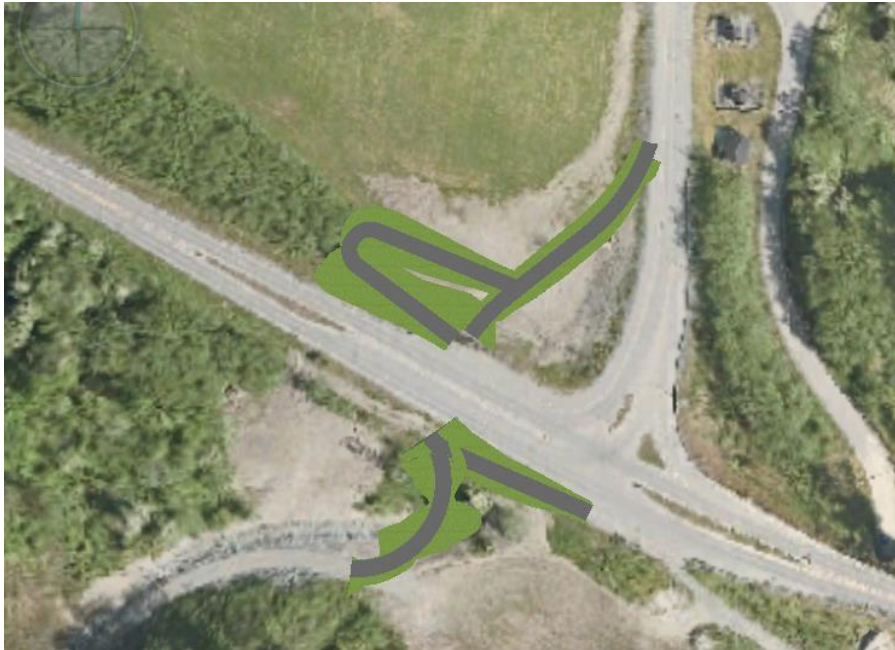
Figur 5-5 Alt 1 - Tilbud for myke trafikanter ledes mot kulvert, kortest mulig gangavstand Brekkåsen - skoleområdet. Eksisterende fortau inn mot fylkesvegen fjernes. Beplantning kan etableres for å lede myke trafikanter bort fra kryssområde
