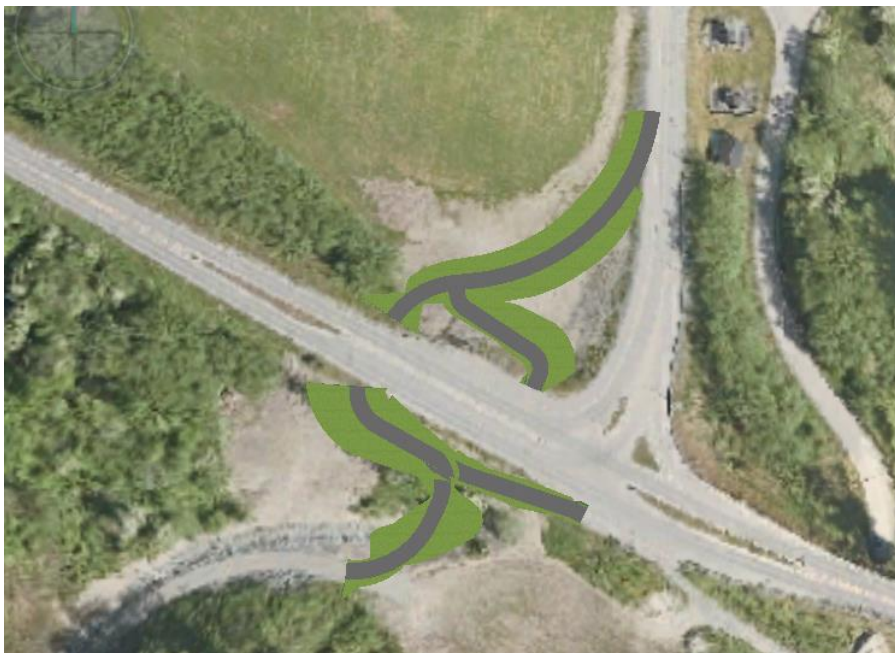
Figur 5-6 Alt 2 - Tilbud for myke trafikanter ledes mot kulvert, kortest mulig gangavstand til bussholdeplasser. Eksisterende fortau inn mot fylkesvegen fjernes. Beplantning kan etableres for å lede myke trafikanter bort fra kryssområde
